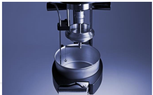
Рисунок 1. RheolabQC оснащено кульковою вимірювальною системою, яка складається з гнучкого тримача чаші, вимірювальної чаші і кулькової вимірювальної системи VM08/QC. Крім цього, використовується зовнішній датчик Pt100 для вимірювання температури зразка.
